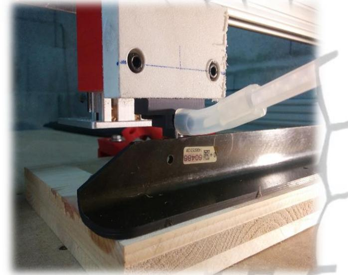
*Dépose automatique de résine*
